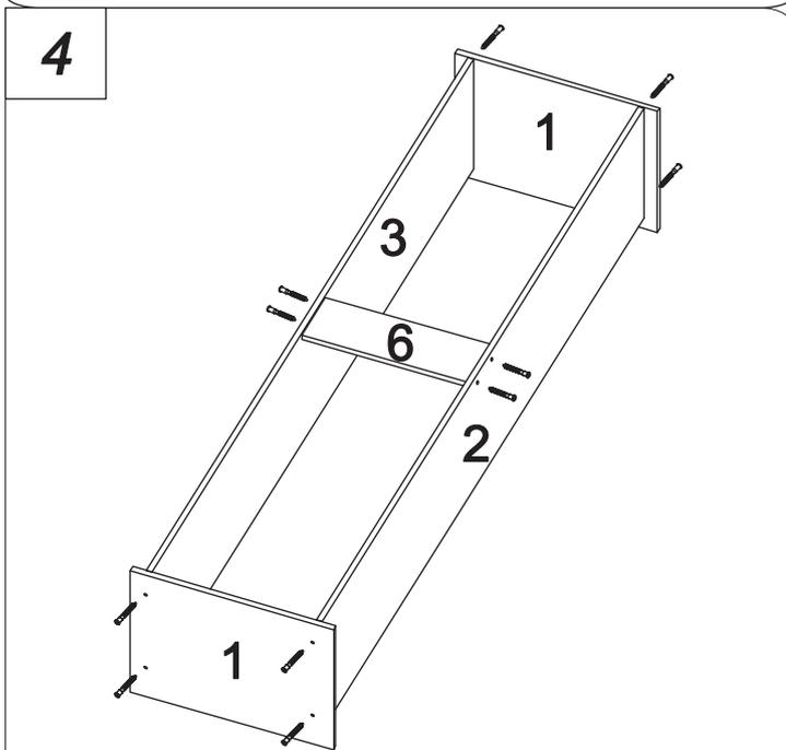
Во избежании смещения соединяемых деталей во время закручивания евровинта, их необходимо удерживать до полной его закрутки.
