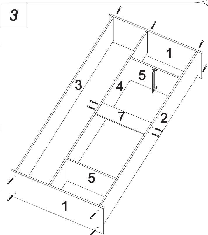
Во избежании смещения соединяемых деталей во время закручивания евровинта, их необходимо удерживаться до полной его закрутки.
